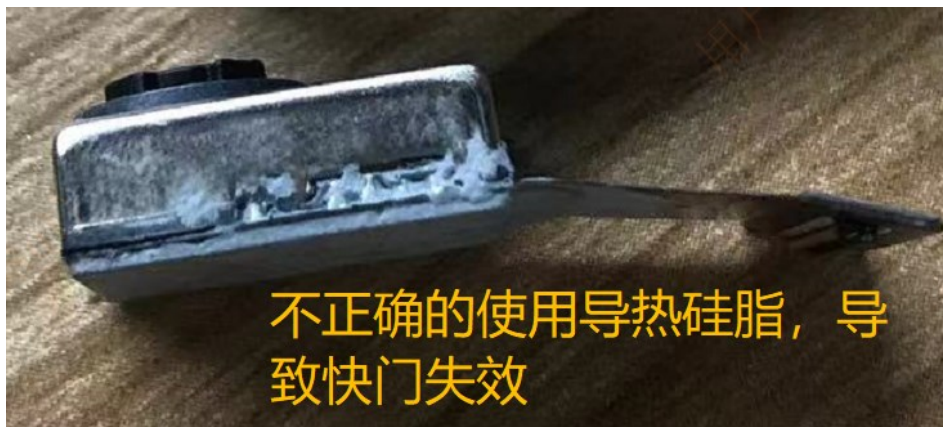
图 22 导热硅脂错误使用示例
